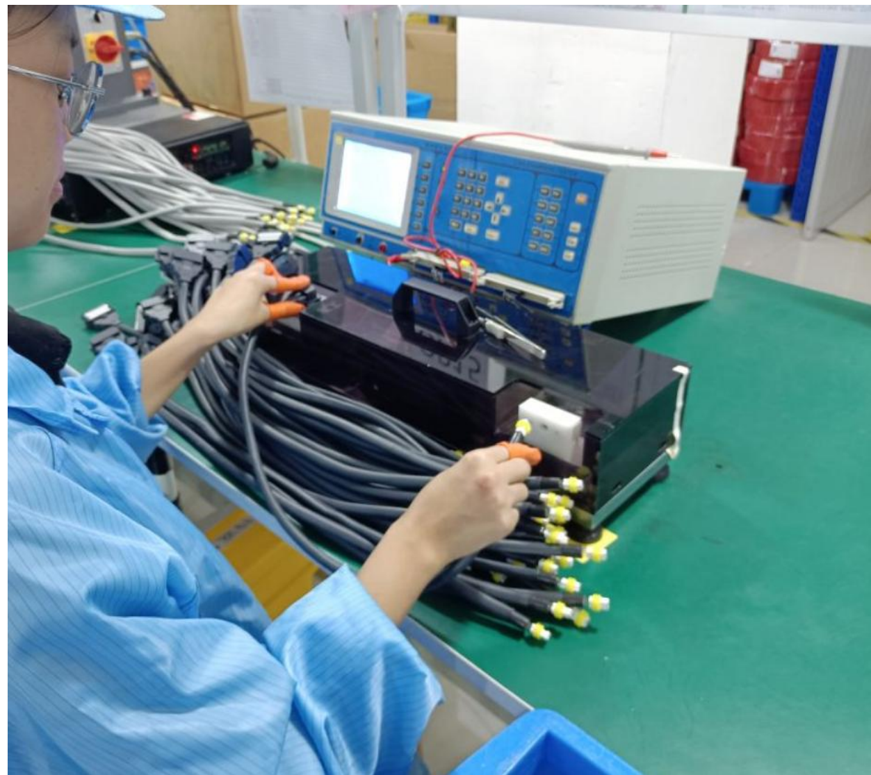
超声波焊接后，需要100%导通全检
